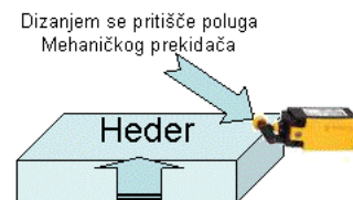
Montaža mehaničkog Start/Stop prekidača Ili prekidača za brojanje prolaza na sijačici
