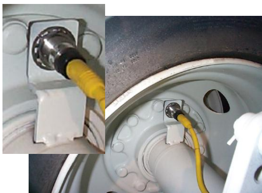
Montaža induktivnog senzora (reagira na vijke kotača)
