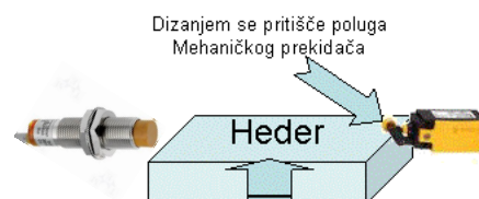
Montaža induktivnog ili mehaničkog Start/Stop prekidača Ili prekidača za brojanje prolaza na sijačici
